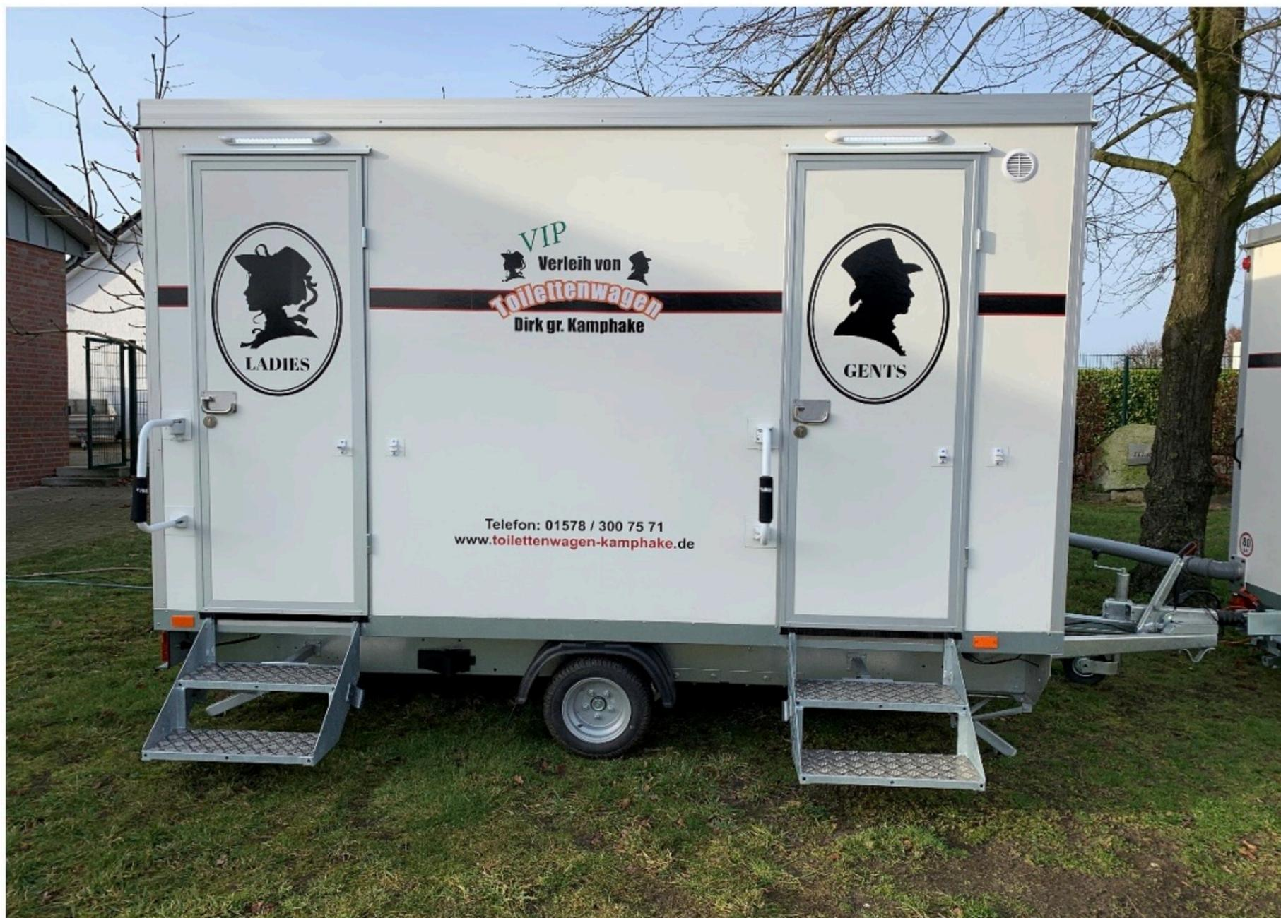
Das Modell VIP Groß hat im Damenabteil 2 einzelne Kabinen und 1 Waschbecken mit Spiegel. Im Herrenabteil befinden sich eine einzelne Kabine sowie 2 Urinale. Ebenso ist hier ein Waschbecken mit Spiegel verbaut. Der Wagen verfügt zudem über eine Musikanlage und eine Heizung, die den Betrieb auch im Winter ermöglicht.
